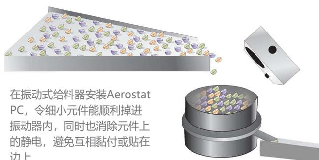
在振动式给料器安装Aerostat PC, 令细小元件能顺利掉进振动器内, 同时也消除元件上的静电, 避免互相黏付或贴在边上。
